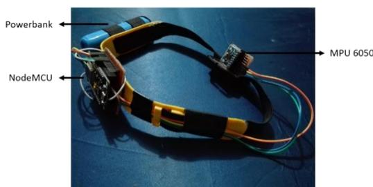
Gambar 2.4.1 Implementasi Prototipe Kontroler dan Rangkaian Elektronik
